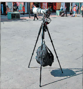
普吉三脚架中轴底部可悬挂重物
